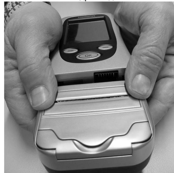
Рис.2. Отсоединение принтера.
